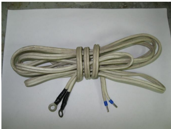
Figura 4.3 Cables de Alimentación para el control del horno y para el receptor..
