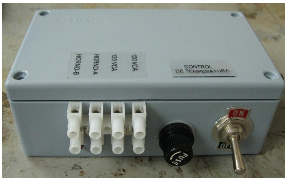
Fig. 3.7 Presentación final del control de temperatura del horno.
