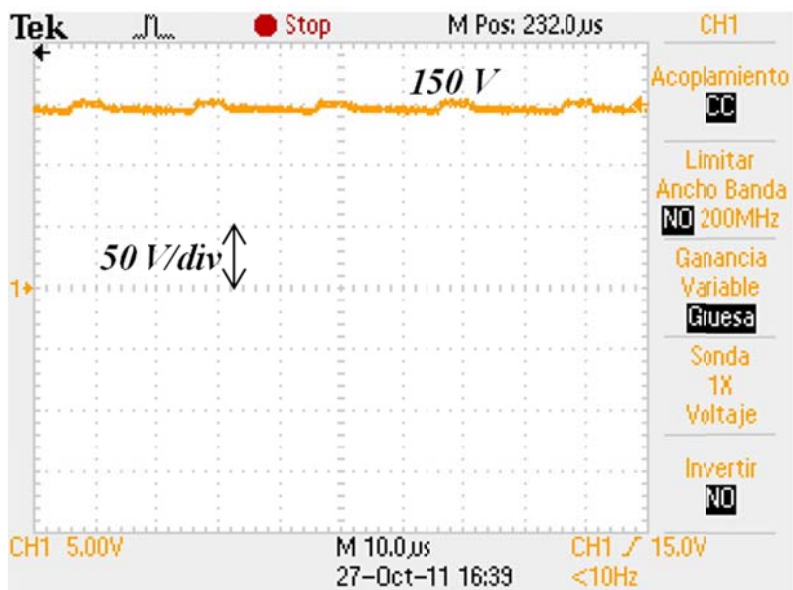
Figura 5. 18 Voltaje en la salida del convertidor.
