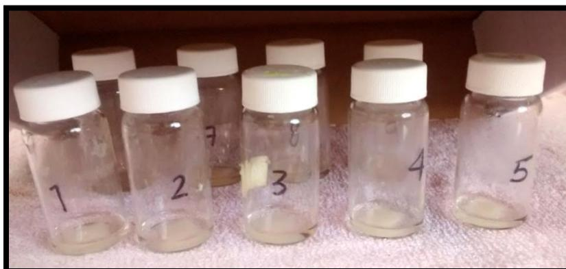
**Figura 2.2** Adición de la solución de KTP a los xerogeles de CMC para realizar la carga del fármaco por hinchamiento
