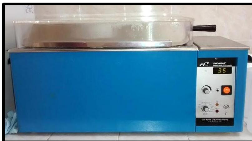
**Figura 2.3** Baño de temperatura constante Cole-Parmer Instrument
