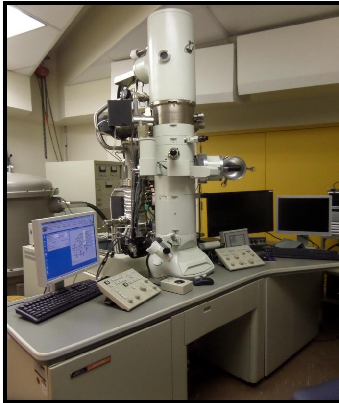
Figura 2.5.- Microscopio de transmisión electrónica marca JEOL JEM-2100f.
