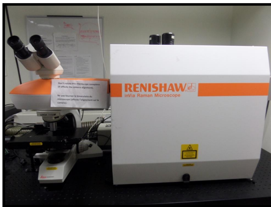
Figura 2.6.- Espectroscopio RENISHAW modelo inVia.
