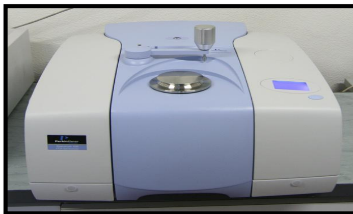
Figura 2.2.- Espectrometro infrarrojo Spectrum 100 (Perkin-Elmer).
