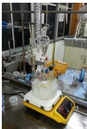
Figura 2.9. a) Sistema de reacción para LIV y b) LIV antes de que se realicen los lavados con tolueno.
