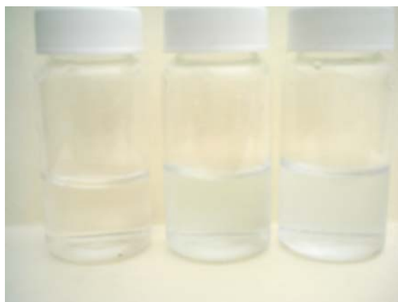
Figura 3.3. De izquierda a derecha , CMC modificada 1, CMC-g-PMMA DP 200 y CMC-g-PMMA DP 300
