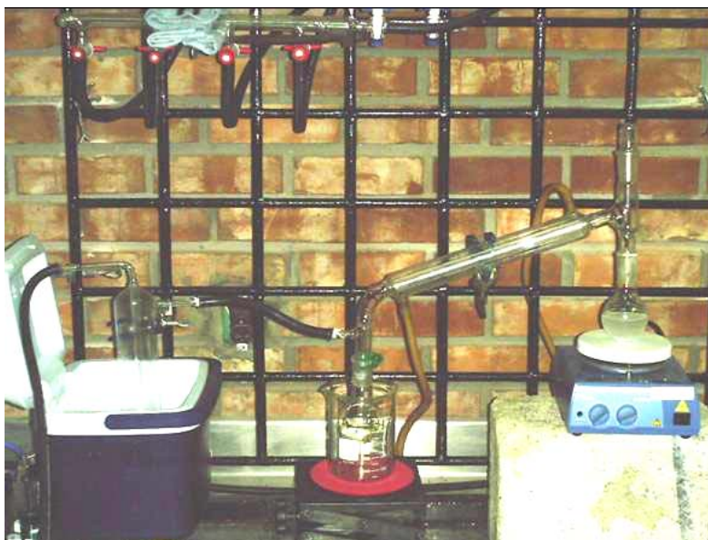
Figura 2.3. Equipo para destilación a vacío
