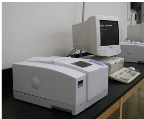
Figura 2.6. Espectrofotómetro IR por Transformada de Fourier marca Perkin Elmer modelo Spectrum One
