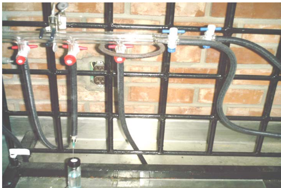
Figura 2.5. Equipo para el suministro de gas inerte ( N_2 ) y vacío.
