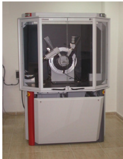
Figura 2.7. Difractómetro de rayos X marca Broker AXS modelo D8 Advance
