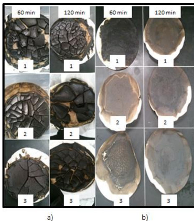
Figura 3.3 a) Muestras de mezcla de lignina residual y cenizas y b) cenizas de cada muestra a 225 °C y a 60 y 120 min
