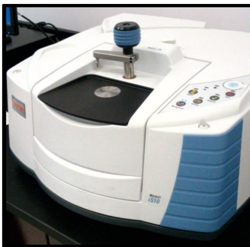
Figura 2.11 Espectrómetro FTIR marca Thermo Scientific y modelo Nicolet iS10
