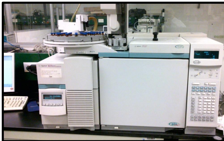
Figura 2.14 Cromatógrafo de gases marca Agilent 6890 Series acoplado a un espectrómetro de masas marca Agilent 5973 Network
