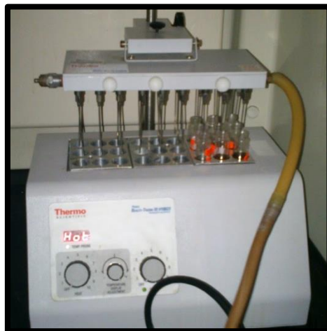
Figura 2.13 Secado y concentración de muestras de aceite fenólico mediante flujo de nitrógeno con el equipo Reacti Therm III de Thermo Scientific.
