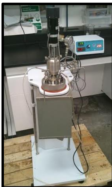
Figura 2.4 Reacción de obtención de lignina en Reactor Prendo RAP-2000
