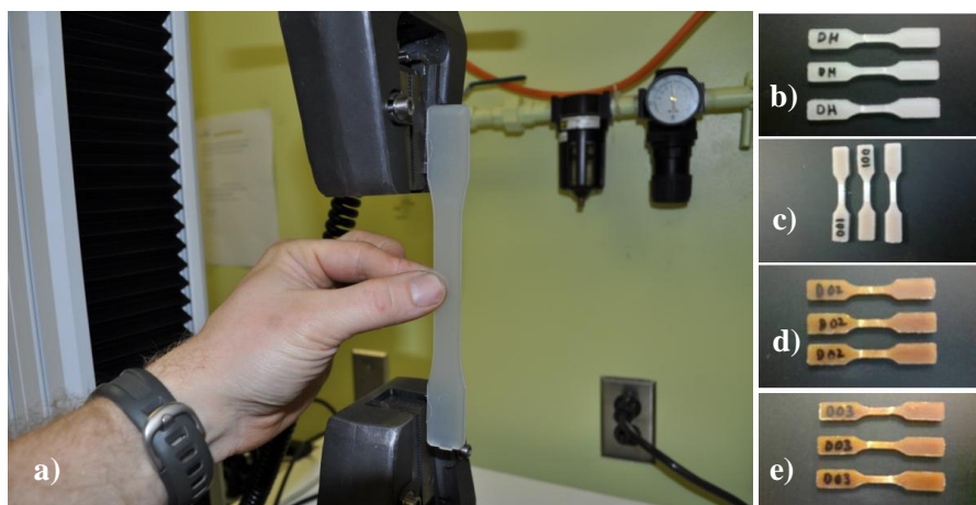
Figura 2.5.7.1. a) Ajuste de las mordazas de la máquina universal Instron y b), c), d) y e) fueron probetas analizadas en el equipo con distintas concentraciones obtenidas en el extrusor doble husillo.
