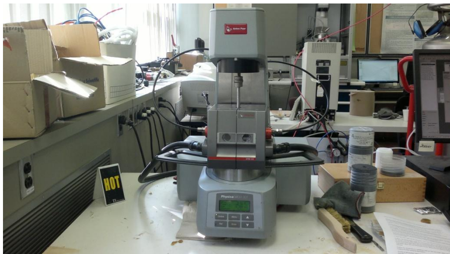
Figura 2.5.5.1. Reómetro Anton Paar CTD 450 con cámara de flujo convectivo de aire y nitrógeno.
