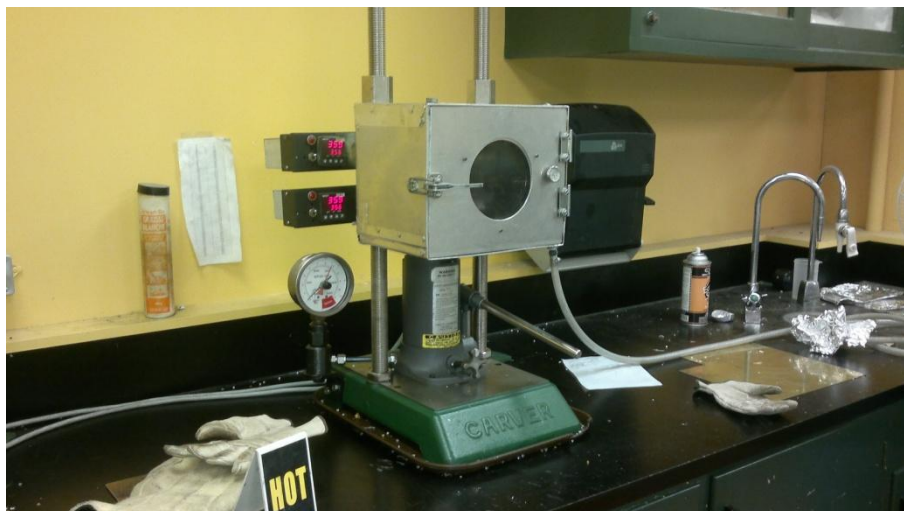
Figura 2.5.1.2. Prensa de hidráulica con placas de calentamiento marca Carver con atmosfera de nitrógeno.
