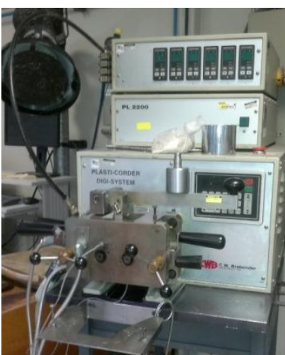
Figura 2.4.2.1. Mezclador interno tipo Brabender del Centro de Investigación de Química Aplicada (CIQA).
