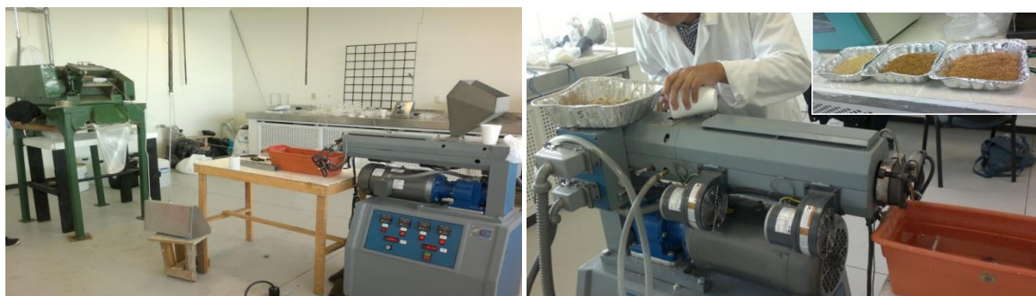
Figura 2.4.2.2. Izquierda, sistema de extrusión utilizado en los NC-BMH, extrusor mono husillo, bandeja de enfriamiento y pelletizadora. Derecha, alimentación manual del equipo mono husillo. Superior derecha, coloración de los NC antes de la segunda etapa del proceso.
