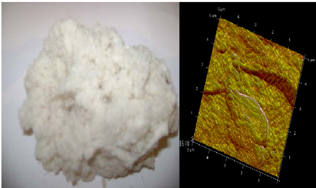
Figura 3.13 Fibra mercerizada recortada y presurizada con su imagen tridimensional AFM.
