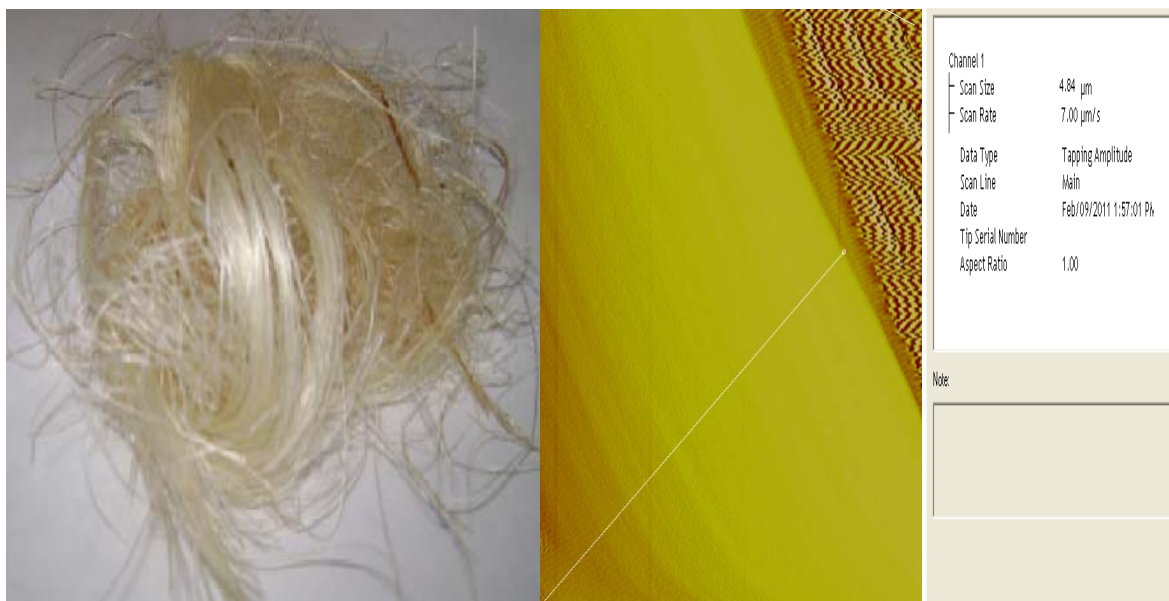
Figura 3.11 Fibra purificada y su espectro AFM usado para medir su longitud.
