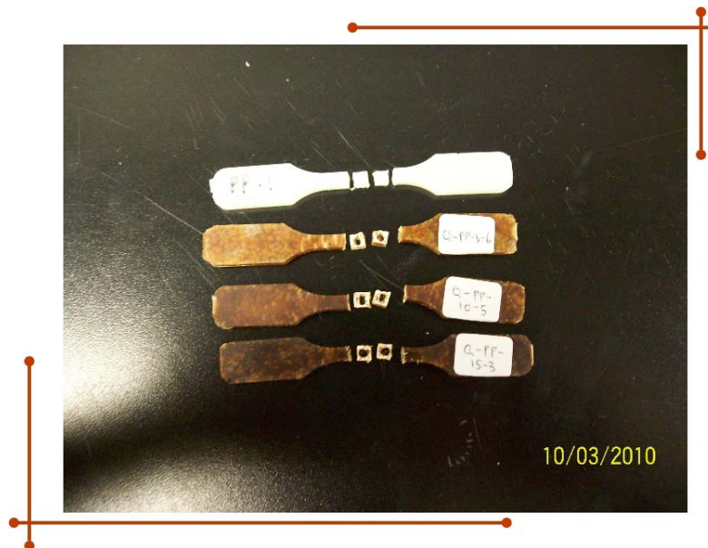
Figura 3.23 Corte efectuado sobre la ruptura de las pruebas tensiles para análisis por SEM.
