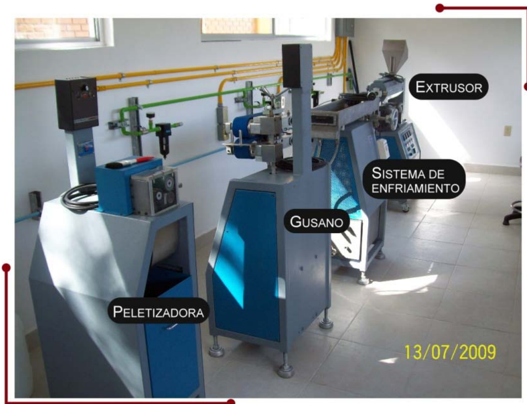
Figura 2.5 Extrusor con equipos auxiliares.
