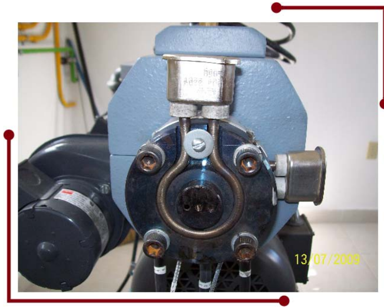
Figura 2.6 Dado de 3 hilos a la salida del extrusor.
