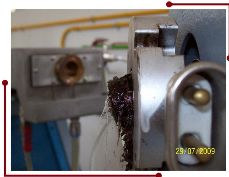
Figura 3.1 Acumulación de material a la salida del extrusor (Q-PP 15%).
