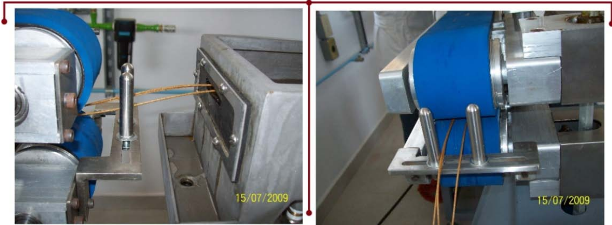
Figura 2.8 Oruga para el jalado continuo y constante de los hilos extruidos.
