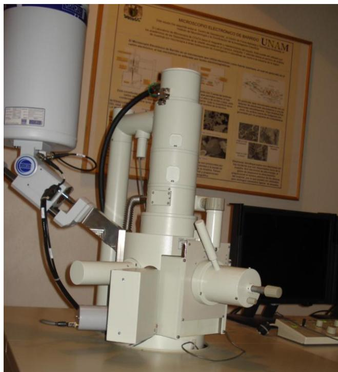
**Figura 2.4** Microscopio Electrónico de Barrido
