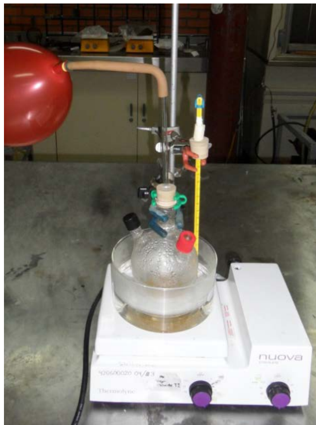
Figura 2.2 Sistema de reacción de los hidrogeles
