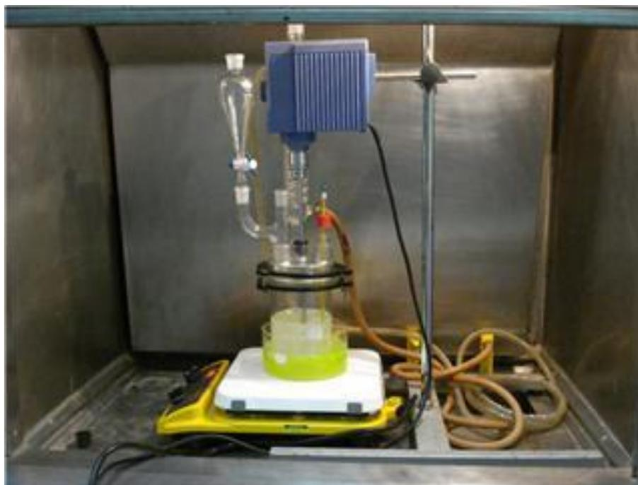
Figura 2.3.- Sistema de reacción para la síntesis del copolímero compatibilizante C-501-GMA
