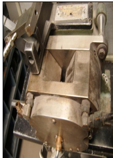
Figura 2.3 Cámara de mezcla.
