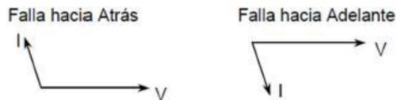
**Figura 2.3 Fasores falla hacia atrás y hacia adelante.**
