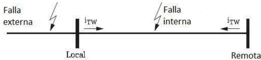
Figura 2.23 Falla interna y externa en línea de transmisión.
