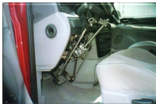
Figura 3.2 Prueba final adaptación del dispositivo
