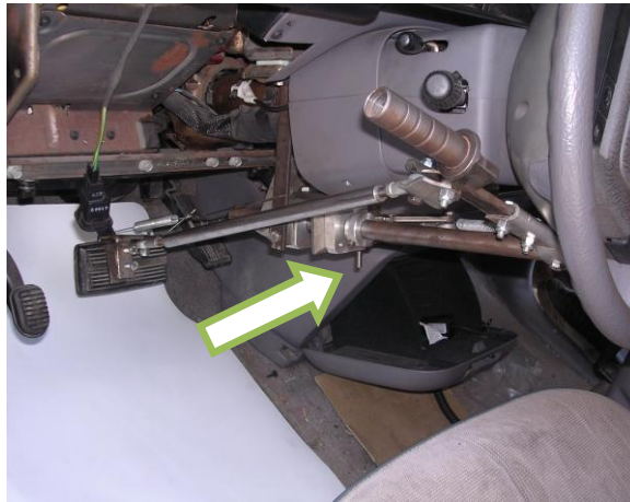
Figura 4.2. Movimiento de los pedales realizando la acción de frenado a través de la palanca del dispositivo.
