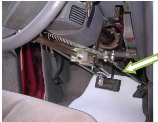
Figura 4.1. Movimiento de los pedales realizando la acción de acelerado a través de la palanca del dispositivo.
