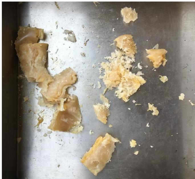
Figura 3.5. SBS 416 con 3 phr Sílice, 5 phr POSS, 190°C, 100 rpm
