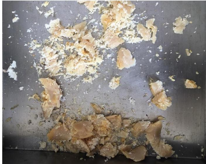
Figura 3.6. SBS 416 con 1 phr Sílice, 5 phr POSS, 190°C, 100 rpm
