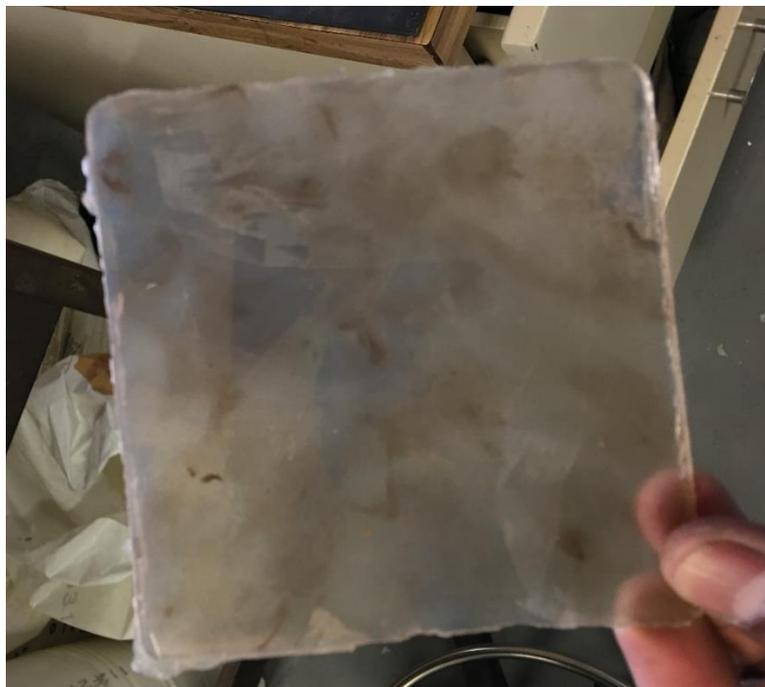
Figura 3.8. Copolímero SBS 416 después de ser compactado en la Prensa.
