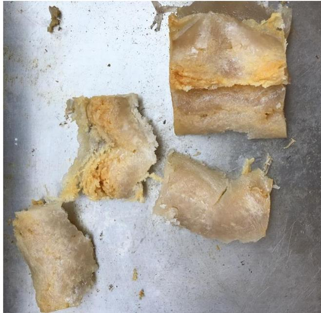
Figura 3.4. SBS 416 con 5 phr Sílice, 5 phr POSS, 190°C, 100 rpm
