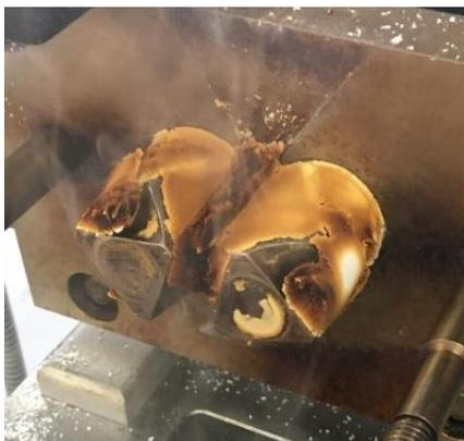
Figura 3.1. SBS 411 a 230°C, 100 rpm y 5 phr de Sílice y POSS respectivamente.
