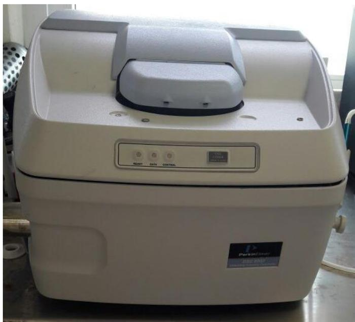
Figura 3.30. Equipo utilizado para el análisis de Calorimetría Perkin Elmer DSC 80000
