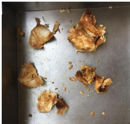
Figura 3.2. SBS 411 a 210°C, 100 rpm y 5 phr de Sílice y POSS respectivamente.
