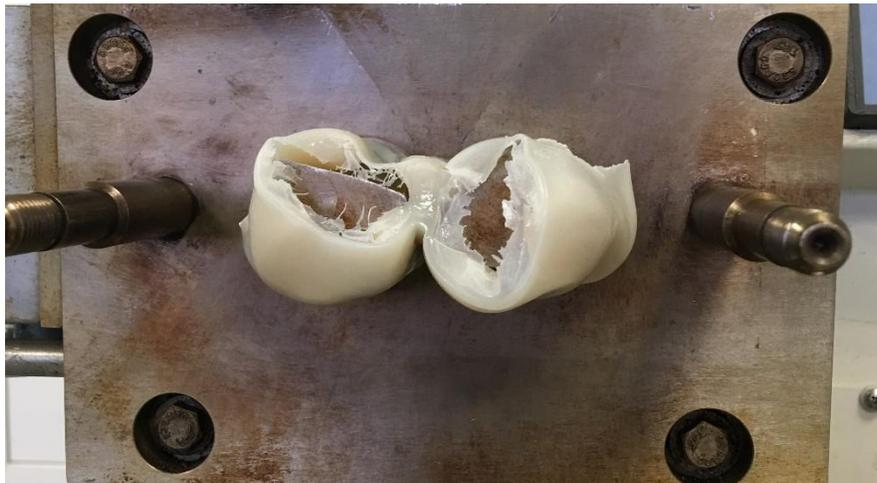
Figura 3.10. Material SBS 416 con 5 phr de POSS y relleno de 1 phr de Sílice
