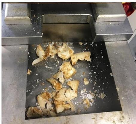
Figura 3.3. SBS 411 a 190°C, 100 rpm y 5 phr de Sílice y POSS respectivamente.
