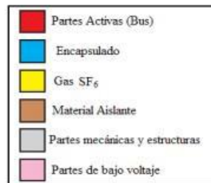
Figura 2.2 Código de colores para una subestación GIS
