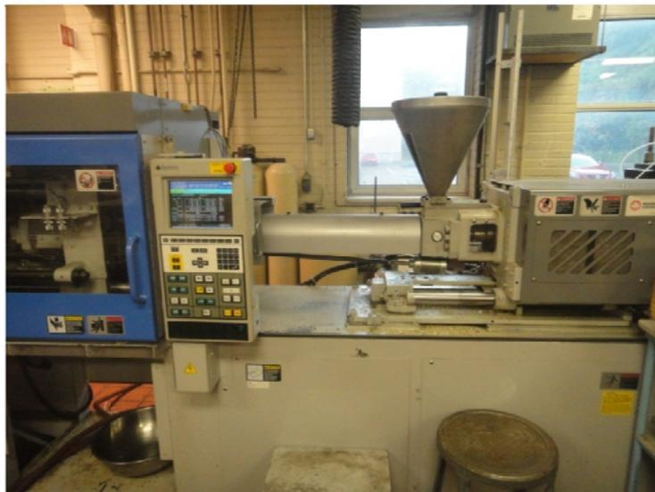
Figura 2.4 Máquina de moldeo por inyección
