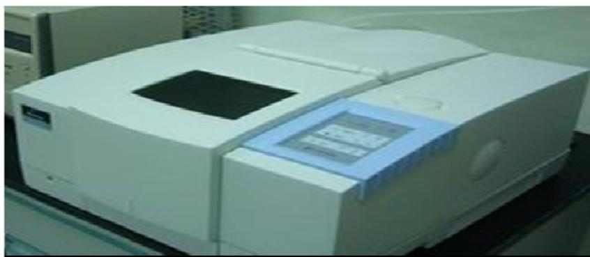
Figura 2.5 Espectrofotómetro IR por Transformada de Fourier (FTIR) marca Perkin Elmer
