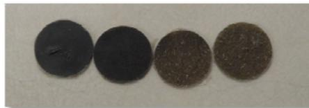
Figura 2.7 Probetas de compósitos de FC/PP para el análisis de reometría
