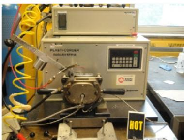
Figura 2. 3 Brabender CW de marca Plastic – Corder Digi –System
