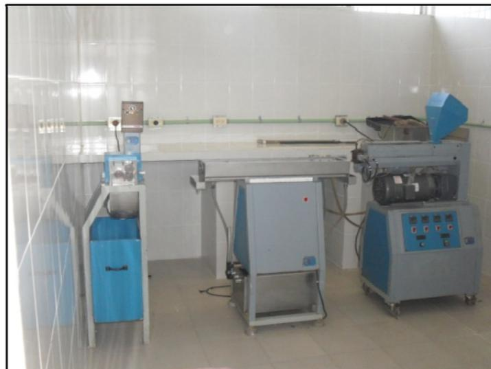
Figura 2.2 Extrusor de simple tornillo
