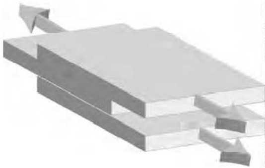
Fig. 2.22 Configuración de elemento para soportar los esfuerzos cortantes.
