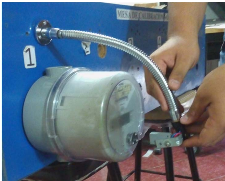
Fig. 2.3 Alineación manual del sensor con el uso del tubo flexible
