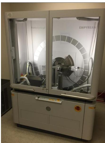
**Figura 2.5.7.1.** Difractómetro de rayos X PANalytical Empyrean.
