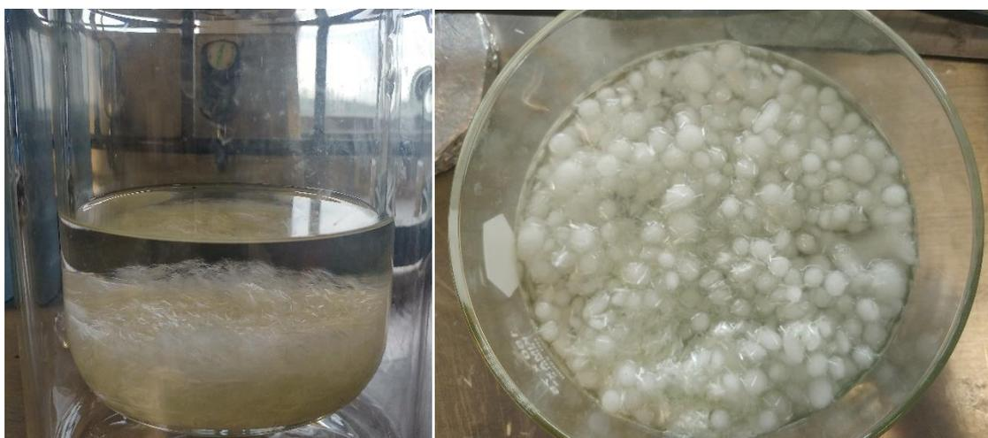
**Figura 2.2.1.** izquierda) Reactor de vidrio utilizado durante la modificación superficial de la fibra de vidrio; b) fibra de vidrio después del tratamiento con TSI-POSS.
