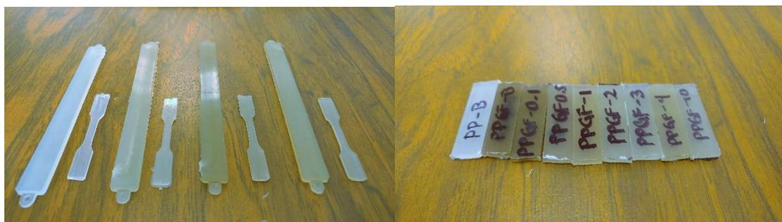
**Figura 2.5.2.1** izquierda) Probetas obtenidas mediante extrusión por inyección para pruebas de impacto y tensiles (dogbone); derecha) placas utilizadas para análisis DMA.
