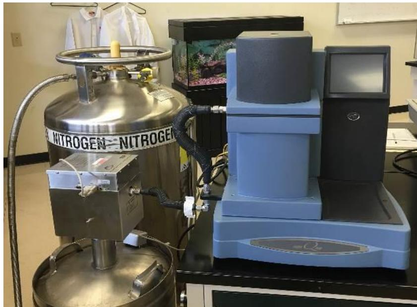
**Figura 2.5.4.1.** Equipo para análisis mecánicos dinámicos marca TA Instruments modelo Q800.
