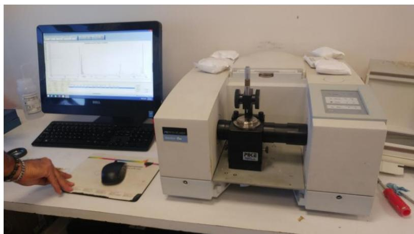
**Figura 2.5.3.1.** Módulo FT-IR Perkin Elmer Spectrum One con ATR punta de ZnSe.
