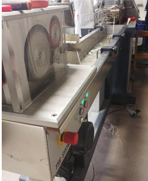
**Figura 2.4.1.2** Sistema de enfriamiento, secado y granulado del material compuesto.
