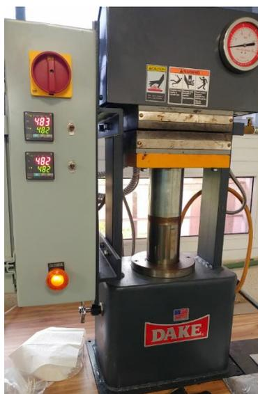
**Figura 2.5.1.1.** Prensa hidráulica de laboratorio Dake 44-225.
