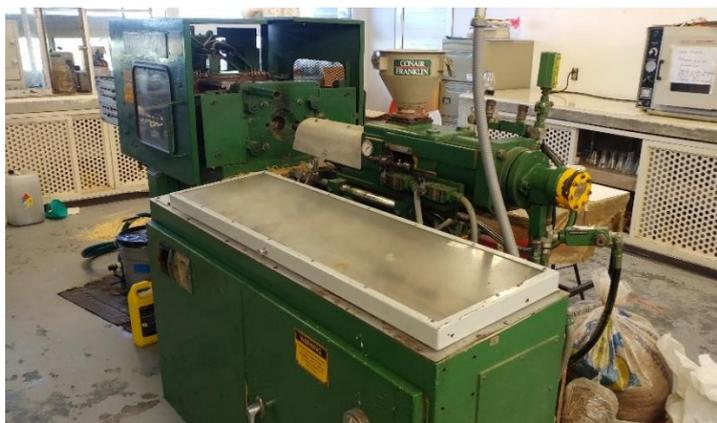
**Figura 2.5.2.2** Inyectora de polímeros Trubor 20JH-RS-1.
