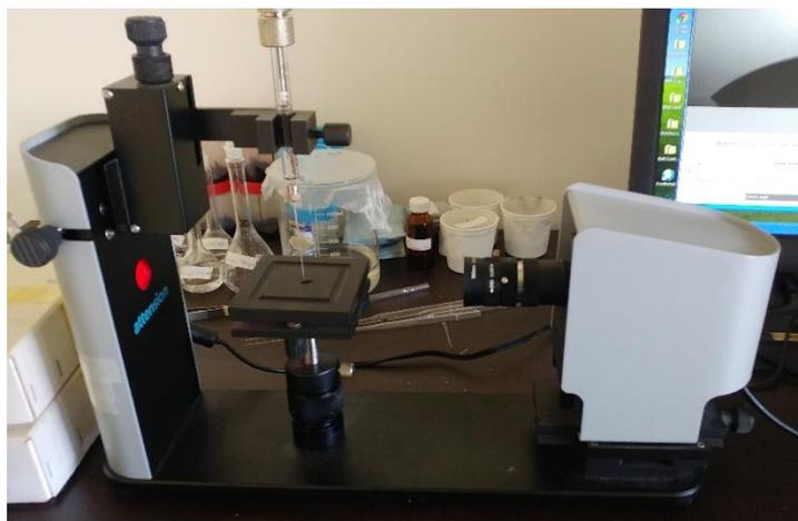
**Figura 2.5.8.1.** Goniómetro marca Biolin Scientific, modelo Attension Theta lite.
