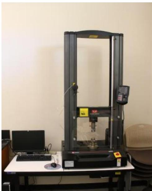
**Figura 2.5.5.1.** Máquina para ensayos tensiles Instron 5969.
