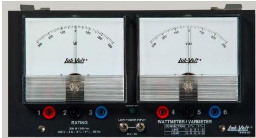
Figura 5.7 Módulo de medición de watts y vars.
