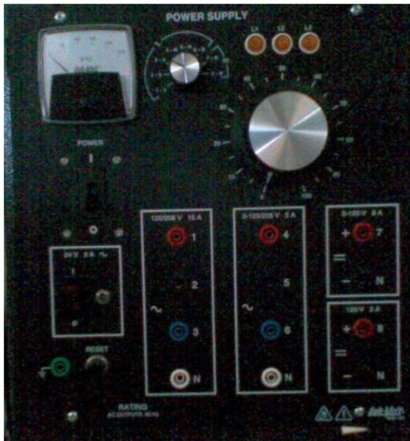
Figura 5.3 Fuente de alimentación Lab-Volt.
