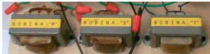
Figura 5.13 Reactor en derivación.
