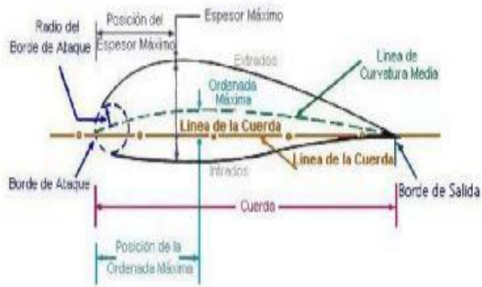
Fig.2.15 Terminología de un Perfil
