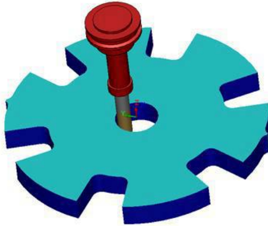
Fig. 4.17 Terminación desbaste del orificio.
