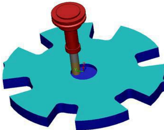
Fig. 4.16 Inicio de Desbaste parte central
