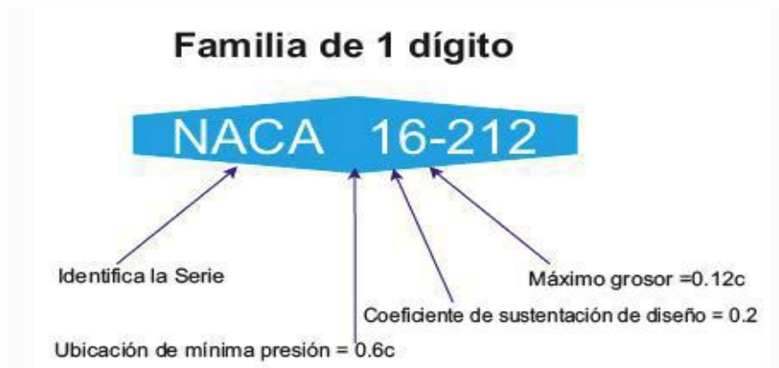
Fig. 2.28 Perfil Alar NACA de 1 Dígito Nomenclatura
