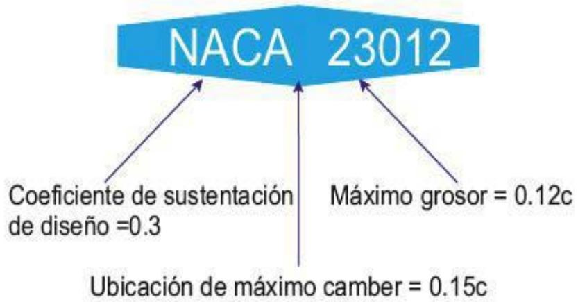
Fig. 2.25 Perfil Alar NACA de 5 Dígitos Nomenclatura
