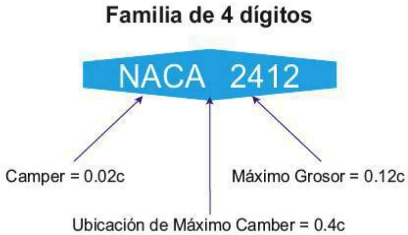
Fig. 2.19 Perfil Alar Naca de 4 Dígitos Nomenclatura
