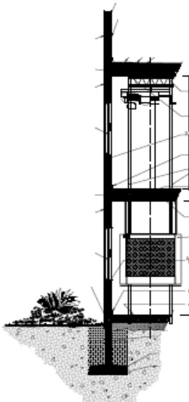
**Figura 3.2.- Componentes del ascensor para personas con capacidades diferentes**
