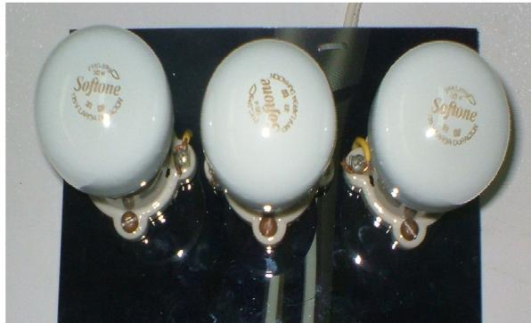
**Figura 5.15.** *Simulación de cargas con focos de 60 watts.*
