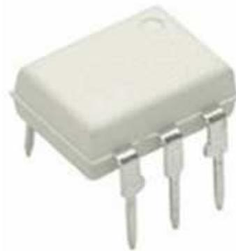
Figura 5.16. Optoacoplador vista externa.
