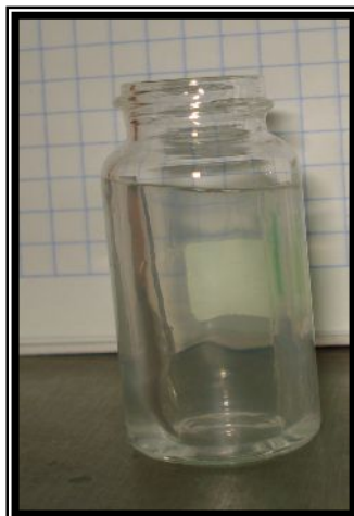
Figura 3.6 Hidrogel totalmente hinchado al equilibrio.
