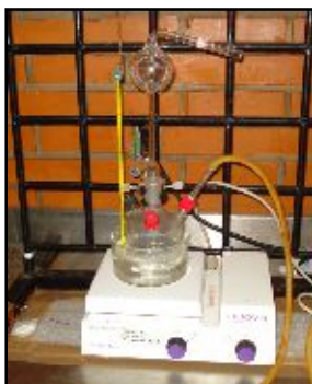
Figura 2.1 Sistema de reacción para la síntesis de hidrogeles de HPC/PAAm.
