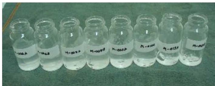
Figura 2.3 Prueba de hinchamiento aplicada a los hidrogeles de HPC/PAAm.
