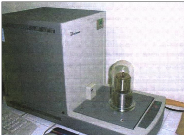
Figura 2.3.- Calorímetro Diferencial de Barrido modelo 2010 marca TA Instruments.
