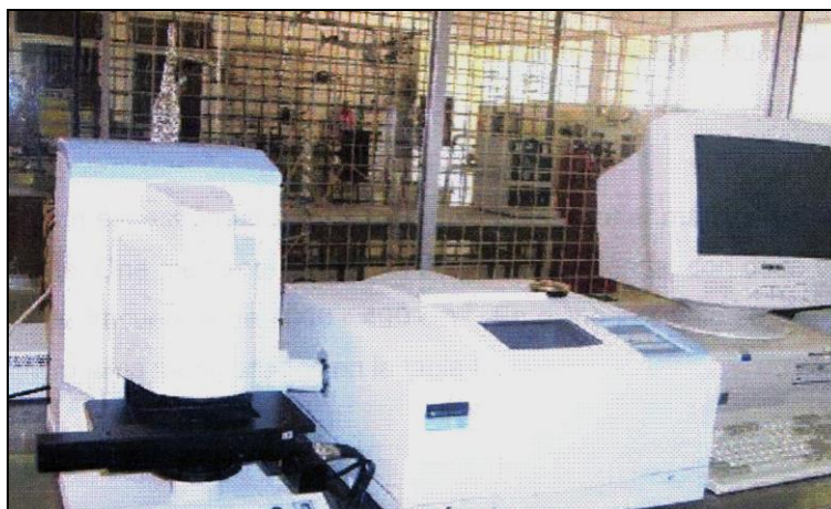
Figura 2.2.- Espectrofotómetro marca Perkin Elmer modelo Spectrum One.
