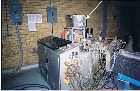
Figura 3-3a Extrusor doble husillo marca W&P y dosificador de gránulos
