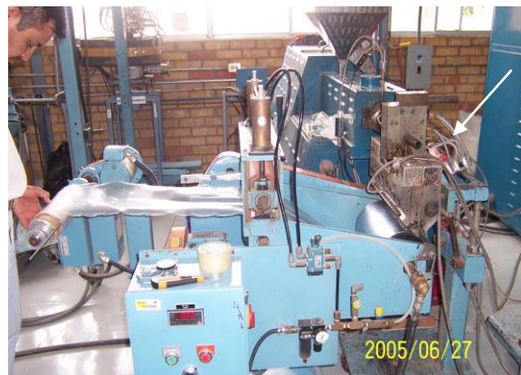
Figura 3-2b Embobinadora vista lateral. La flecha señala el dado de película plana
