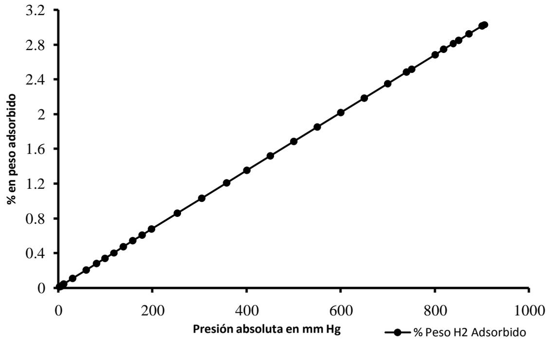
Figura 3.70 Isoterma de adsorción de Hidrógeno en % peso en el material SBA-16/NTC/NiMo
