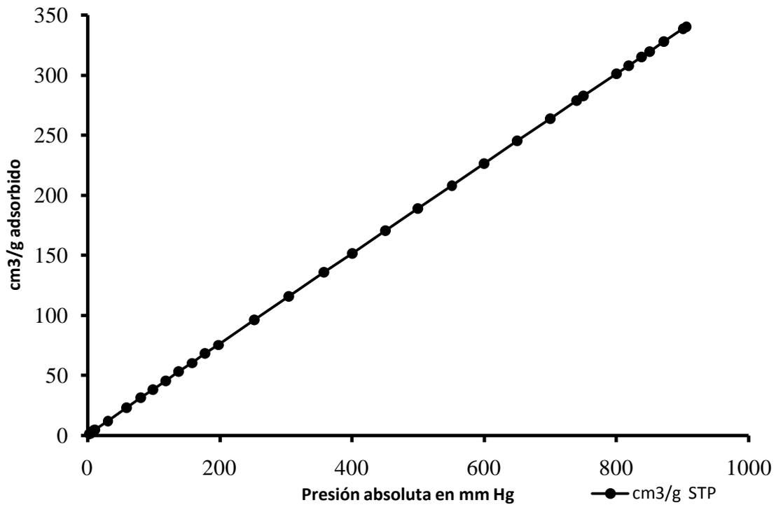
Figura 3.69 Isotherma de adsorción de Hidrógeno en el material SBA-16/NTC/NiMo
