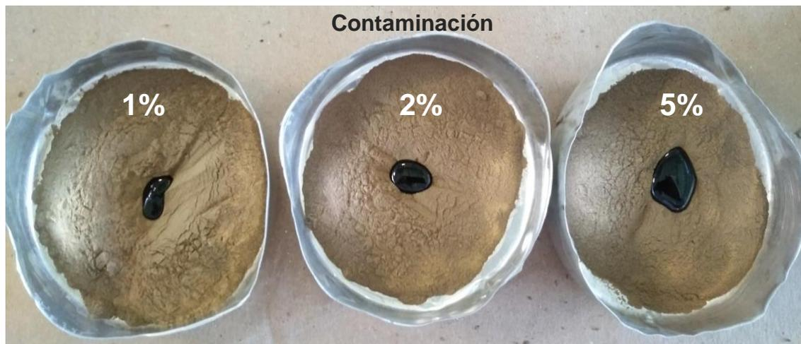
*Figura 4.10. Contaminación del sustrato al 1%, 2% y 5 % en peso.*
