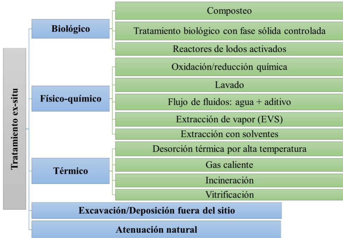
*Figura 3.5. Técnicas de remediación ex situ.*
