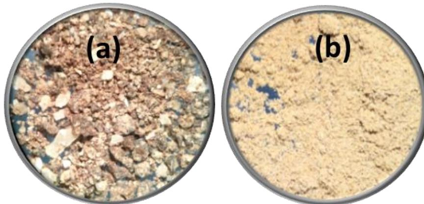
*Figura 5.2. Imagen con microscopio estereoscópico a) suelo grueso, b) suelo fino.*
