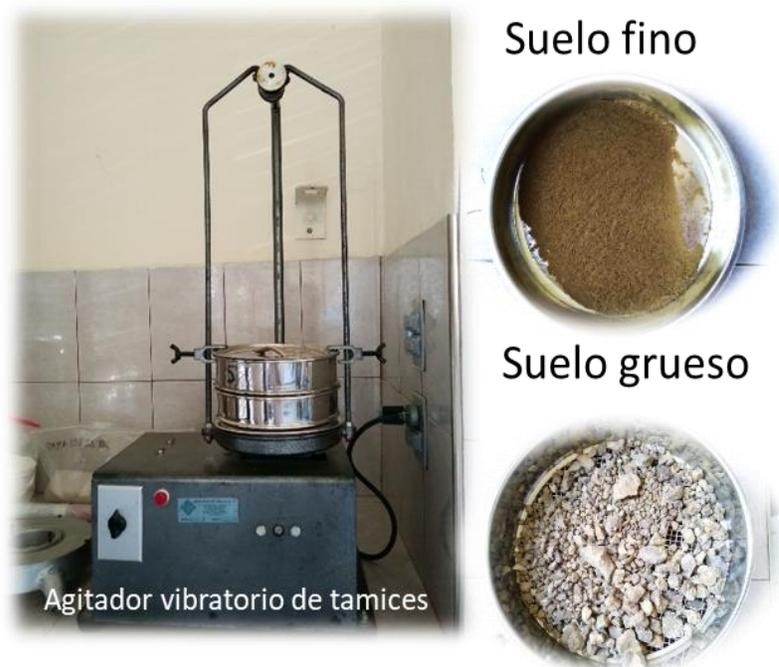
*Figura 4.4. Separación del suelo en sus fracciones de suelo fino y suelo grueso.*
