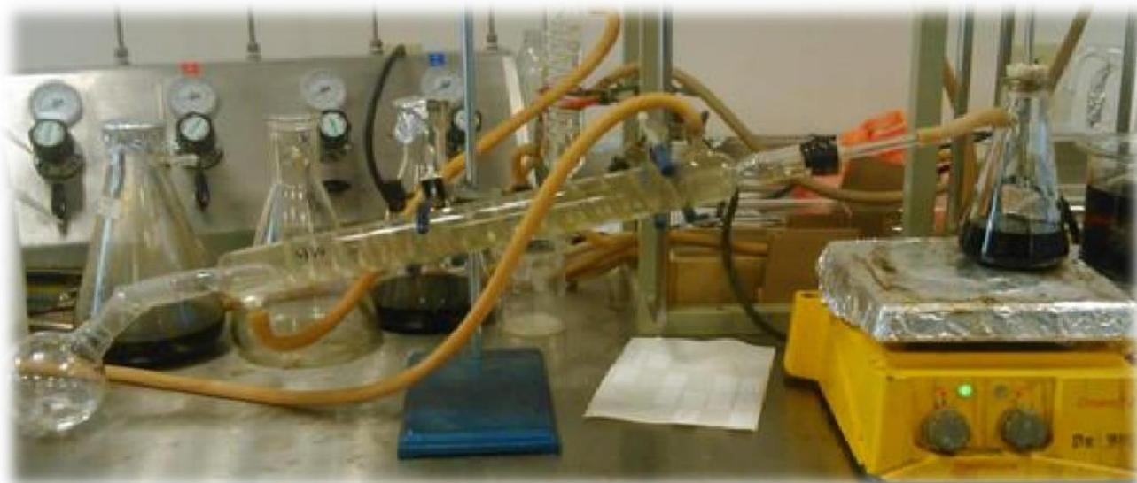
**Figura 3.3** Sistema para la destilación del tolueno.
