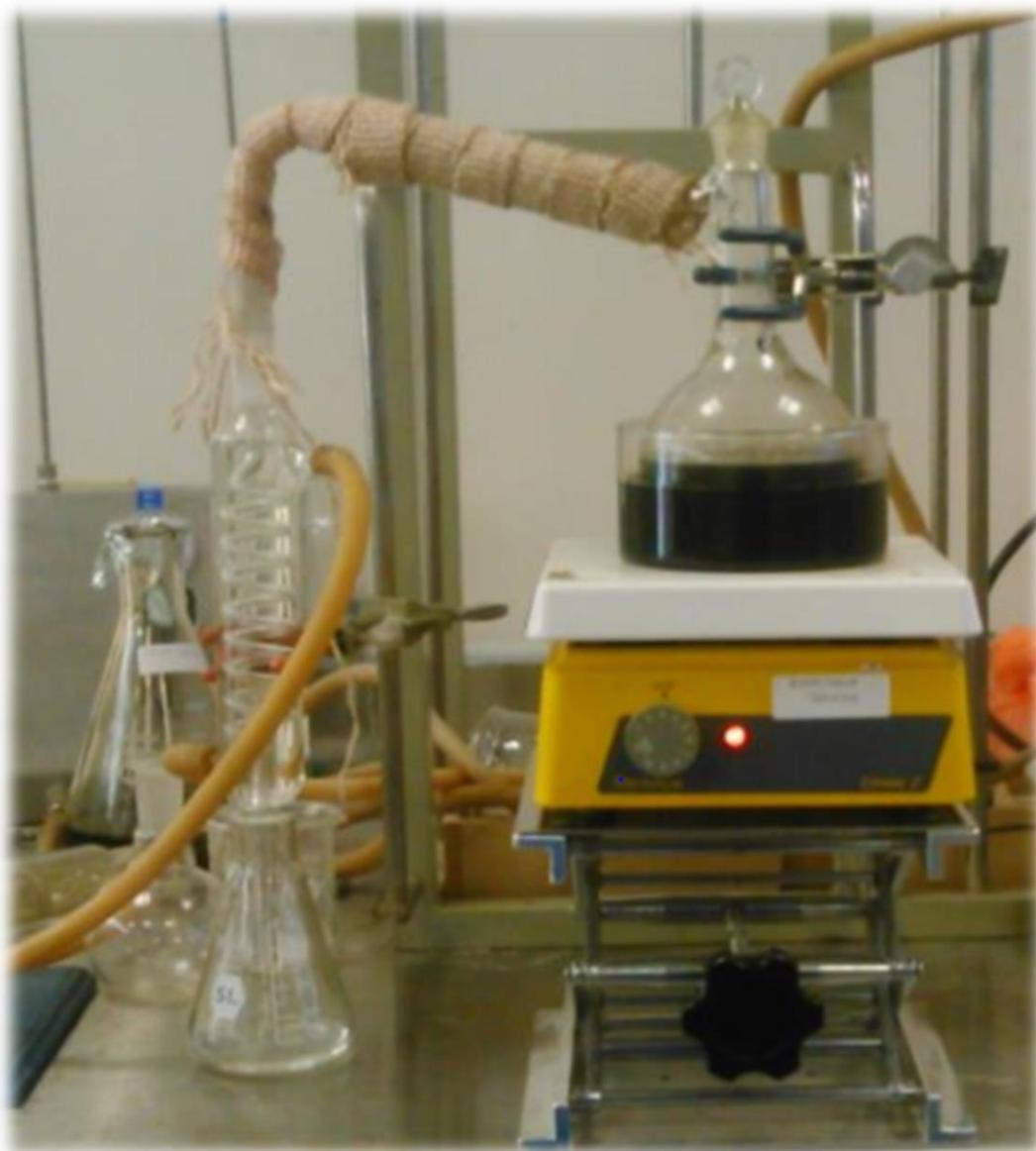
**Figura 3.5** Sistema para la destilación de n-heptano..
