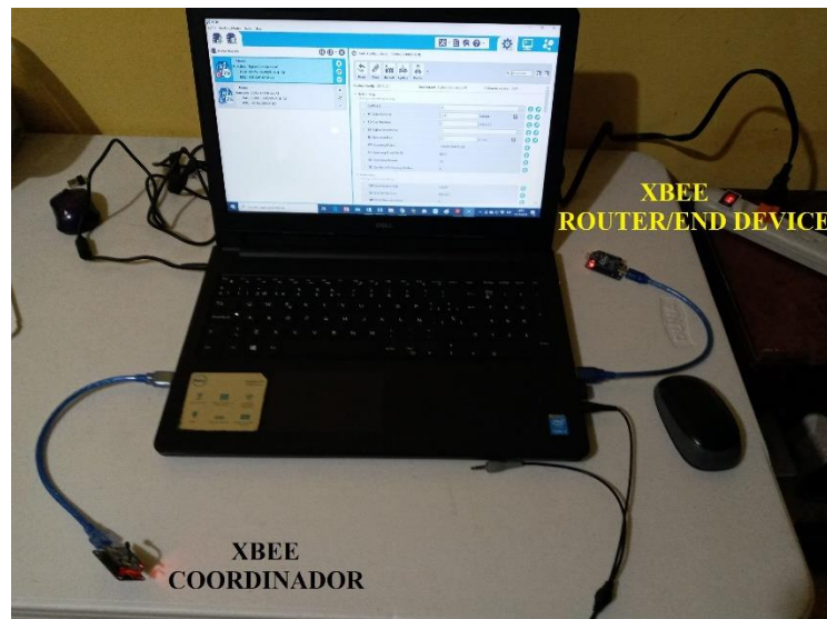
Figura 5.4. Conexión de módulos Xbee para prueba de comunicación.
