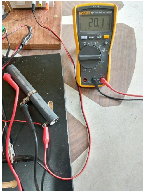
Figura 5.15. Valor de carga intermedia 20 \Omega .
