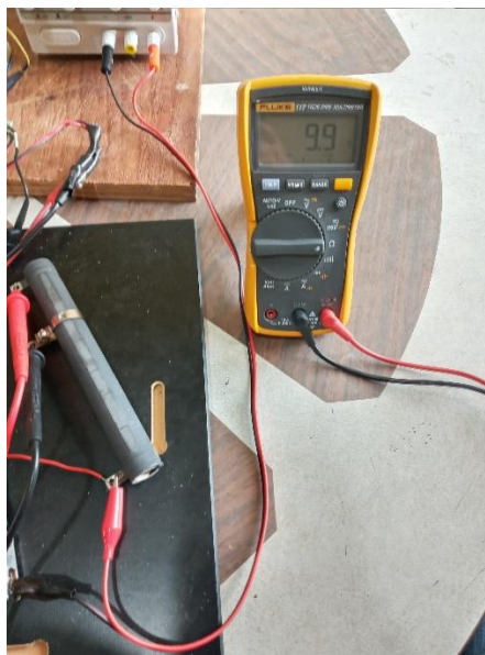
Figura 5.18. Valor de carga alta 10\Omega .
