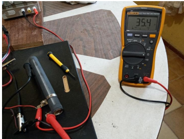
Figura 5.12. Valor de carga baja 35 \Omega .
