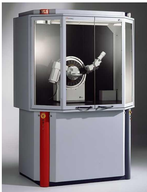
Figura 15. Difractómetro D8 Bruker Advance.
