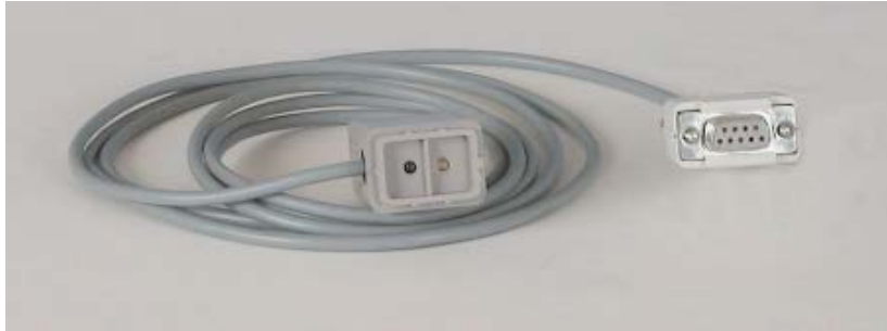
Figura 3.3 Cable de comunicación entre el REL 316*4 y la PC.
