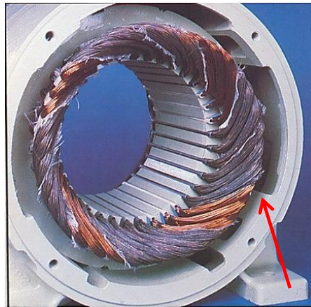
Figura 2.8. Daño por pérdida de una fase en un motor conectado en estrella.
