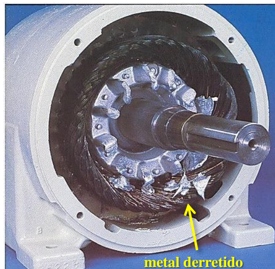
Figura 2.16. Daño en el aislamiento del bobinado por rotor bloqueado (metal derretido).
