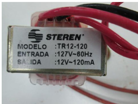
Figura 4.1. Características del transformador 127/12 V.
