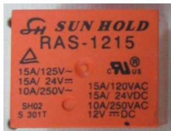
Figura 4.30. Relevador SUN HOLD RAS – 1215.
