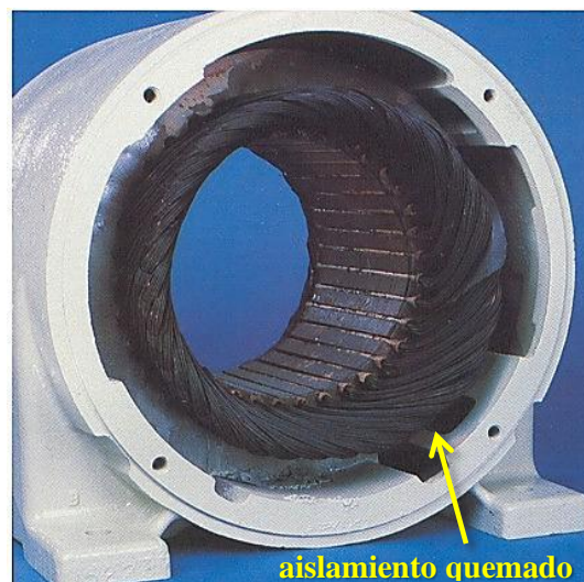
Figura 2.15. Daño en el aislamiento causado por una sobrecarga.
