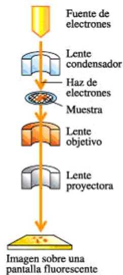
Figura 2. 3. Esquema de un microscopio electrónico de transmisión
