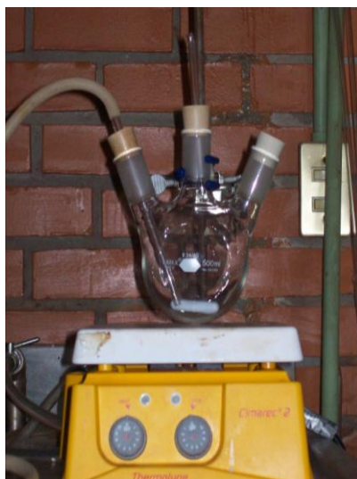
Figura 2. 2. Montaje del equipo para la síntesis de NIO
