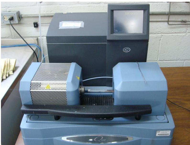
**Figura 2.1** Equipo para el análisis TGA - DTA
