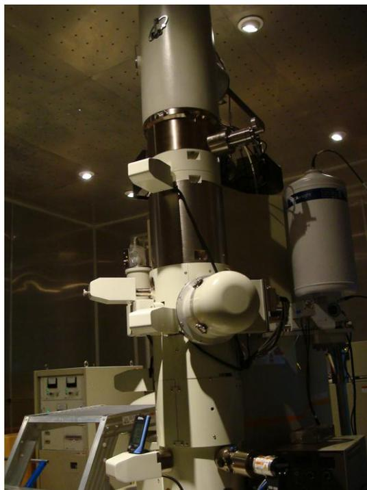
**Figura 2.10** Microscopio Electrónico de Transmisión Philips CM 200
