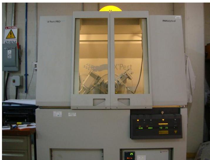
Figura 2.3 Difractómetro de rayos X
