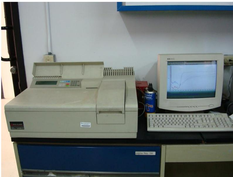
**Figura 2.5** Espectrofotómetro UV- visible
