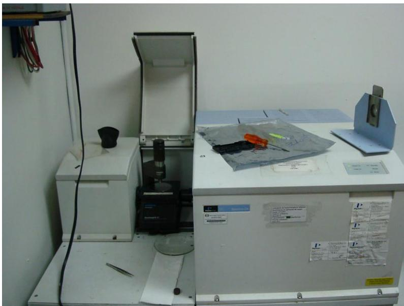
**Figura 2.4** Espectrómetro de infrarrojos
